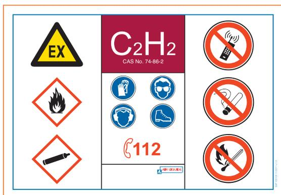
Support regroupant l'ensemble des panneaux réglementaires rappelant les dangers liés au stockage et à l'utilisation de l'acétylène ; les interdictions s'y rapportant ; ainsi que les obligations pour la manipulation.
