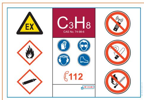
Support regroupant l'ensemble des panneaux réglementaires rappelant les dangers liés au stockage et à l'utilisation du propane (GPL) ; les interdictions s'y rapportant ; ainsi que les obligations pour la manipulation.
